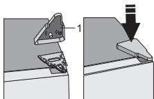
Entfernen Sie die obere Scharnierabdeckung (1).
