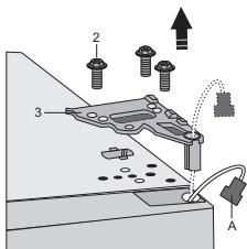
Lösen Sie die Schrauben (2) und entfernen Sie das Scharnier (3). Führen Sie den Steckverbinder (A) durch das Loch im Scharnier. Halten Sie die Tür dabei fest, damit sie nicht herunterfällt.
