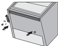
Verwenden Sie die Schrauben, um den Fuß von Schritt 11 und das untere Scharnier von Schritt 12 auf der gegenüberliegenden Seite zu befestigen.
